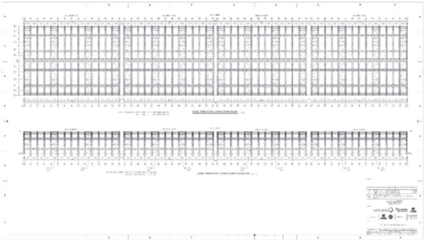
Fig. 5 - Pianta e sezione longitudinale di un hangar
